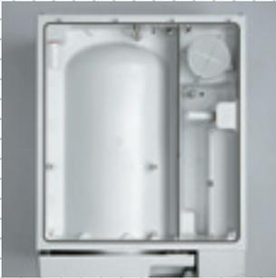
**“Inspectionnabilité”** De par son système d’inspection simple et rapide, les réservoirs du E9 Med peuvent être vérifiés et nettoyés directement par l’opérateur, sans que cela ne nécessite l’intervention d’un technicien spécialisé. L’eau utilisée pour la stérilisation est ainsi toujours propre, pour garantir une vapeur de qualité, et donc, une stérilisation entièrement fiable.
