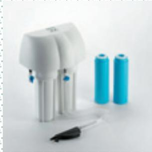
**Aquafilter** Dispositif pour la production d'eau déminéralisée en conformité aux directives de la norme EN13060 (< 15 us/cm). En réduisant les sels, on évite la formation de dépôts, aussi bien à l'intérieur de la chambre que sur les instruments. Il peut-être connecté directement au réseau d'eau et alimenter, non pas un, mais deux autoclaves E9 ainsi que le pistolet distributeur. Sa capacité de production d'eau est de 60 litres/heure. Dimensions : 320x420x180 mm (LxHxP).
