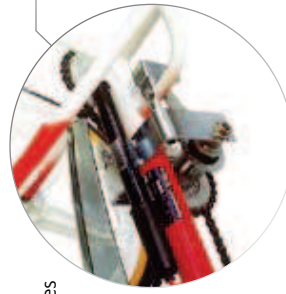
Dérailleur 5 vitesses indexées avec roue libre intégrée (T3/T4)
