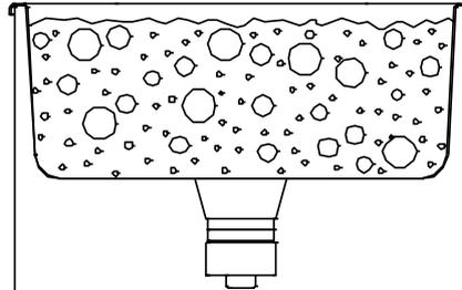
En implosant, les microbulles dégagent de l'énergie qui, par leur force de choc, décrochent les particules contaminantes présentes sur les objets plongés dans le liquide en question.
