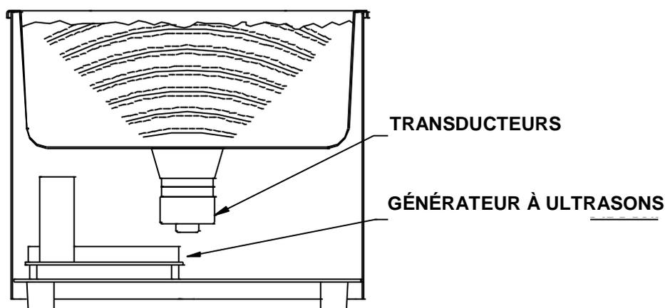
La cuve à ultrasons EUROSONIC® 3D possède un système de vibration à patinage de fréquence. Avec ce type de fonctionnement « brisent ». Ceci permet d'obtenir une meilleure uniformité de vibration et un nettoyage plus efficace et plus rapide des objets.
