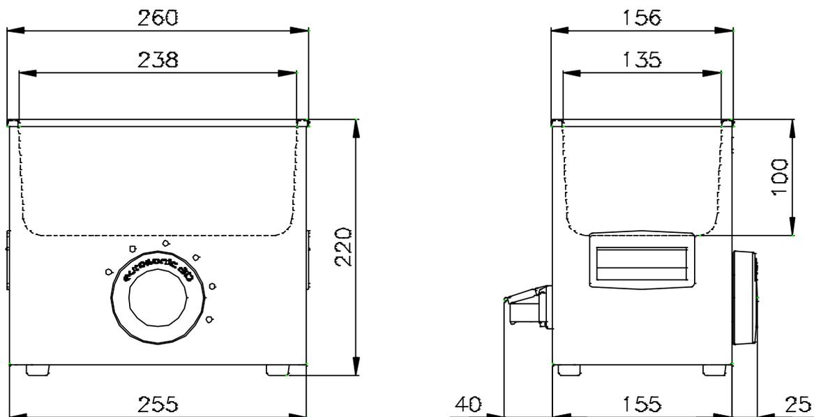
Dimensions de la cuve à ultrasons 3D avec couvercle et panier
