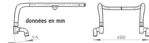
position 20 mm plus en arrière et 20 mm par côté plus rapprochée du cadre
