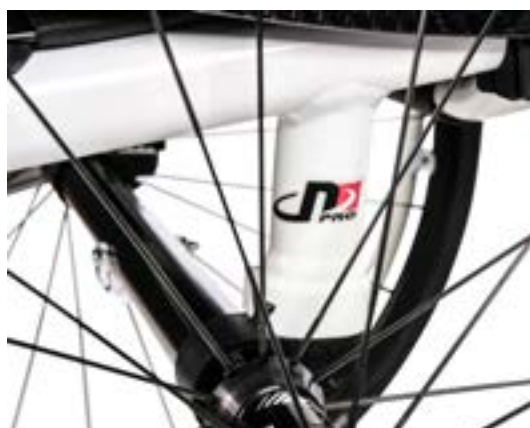
// Détail - support d'axe soudé & logo Nitrum Pro
