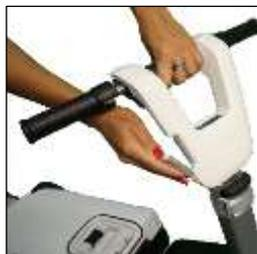
Schéma 19 Levier de basculement de la console de conduite
