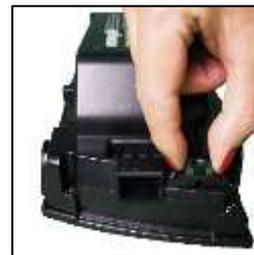
Schéma 65 Remplacement d'un fusible grillé
