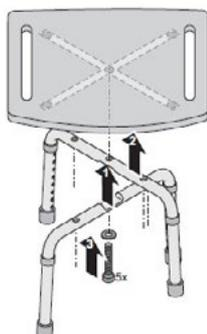
2. Emboîter les 4 pieds en veillant à ce que les boutons poussoirs soient parfaitement et complètement enclenchés dans les trous. S'assurer que les 4 embouts antidérapants soient suffisamment enfoncés.
