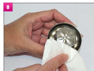
Avant de lancer un nouveau broyage, essuyez la tête de broyage avec une lingette sèche à usage unique pour éviter la contamination croisée. Cette étape n'est pas nécessaire en cas d'utilisation de rondelle.
