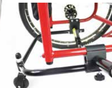
Centre de gravité réglable et roulette anti-bascule à démontage rapide.
