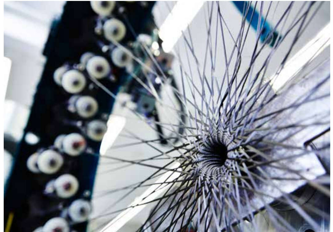
Procédé de tressage des filaments de carbone réalisé par robots pour confectionner les tubes de châssis du Krypton.
