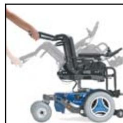
Arceau de type poussette en option, basculement manuel sans outils, hauteur réglable et repli pour le transport
