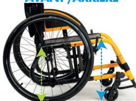
Sur votre **Trigo**, la hauteur d'assise avant (flèche bleue) est obtenue en retirant le coussin d'assise et en mesurant la distance entre le sol et l'avant de la toile. De la même façon, la hauteur d'assise arrière (flèche verte) est obtenue en mesurant la distance entre le sol et l'arrière de la toile.
