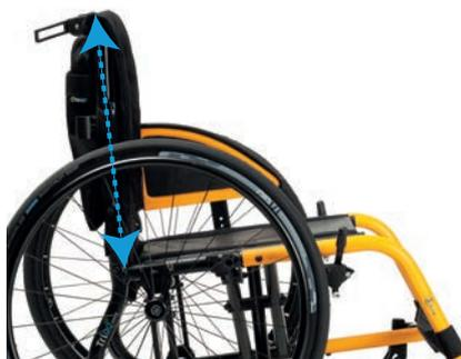
Sur votre **Trigo**, la hauteur de dossier est obtenue en retirant le coussin d'assise et en mesurant la distance entre la base du tube du dossier et le bord supérieur de la toile de dossier.
