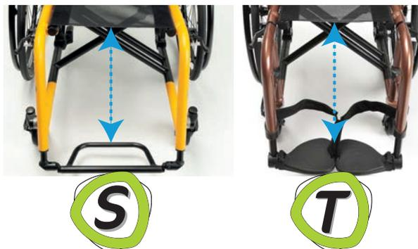
Sur votre **Trigo**, l'UL ou longueur de jambes est obtenue en retirant le coussin d'assise et en mesurant la distance entre l'avant de la toile d'assise et le bord intérieur de la palette de repose-pieds.
