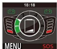
2, Lorsque la puissance est inférieure à 10%, l'indicateur est dans le rouge. La puissance est trop faible, le véhicule s'arrêtera automatiquement quelques minutes plus tard.
