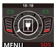
3, L'écran LCD montre l'état de charge actuel. Lorsque vous insérez le chargeur, l'écran LCD montrera que la batterie charge et l'indicateur clignotera. N'utilisez pas le véhicule pendant ce temps.
