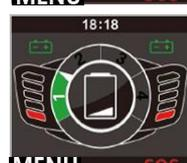
5, Lorsque la puissance est inférieure à 10%, l'indicateur passe au rouge, montrant que vous ne devez plus bouger, le véhicule risque de s'arrêter automatiquement.
