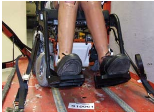
Point d'attache avant du fauteuil
