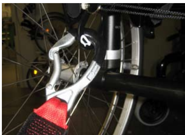
Point d'attache arrière du fauteuil
