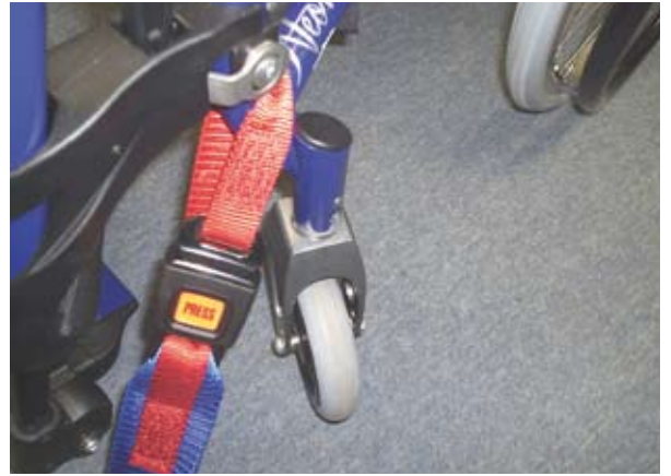
Point d'attache avant du fauteuil
