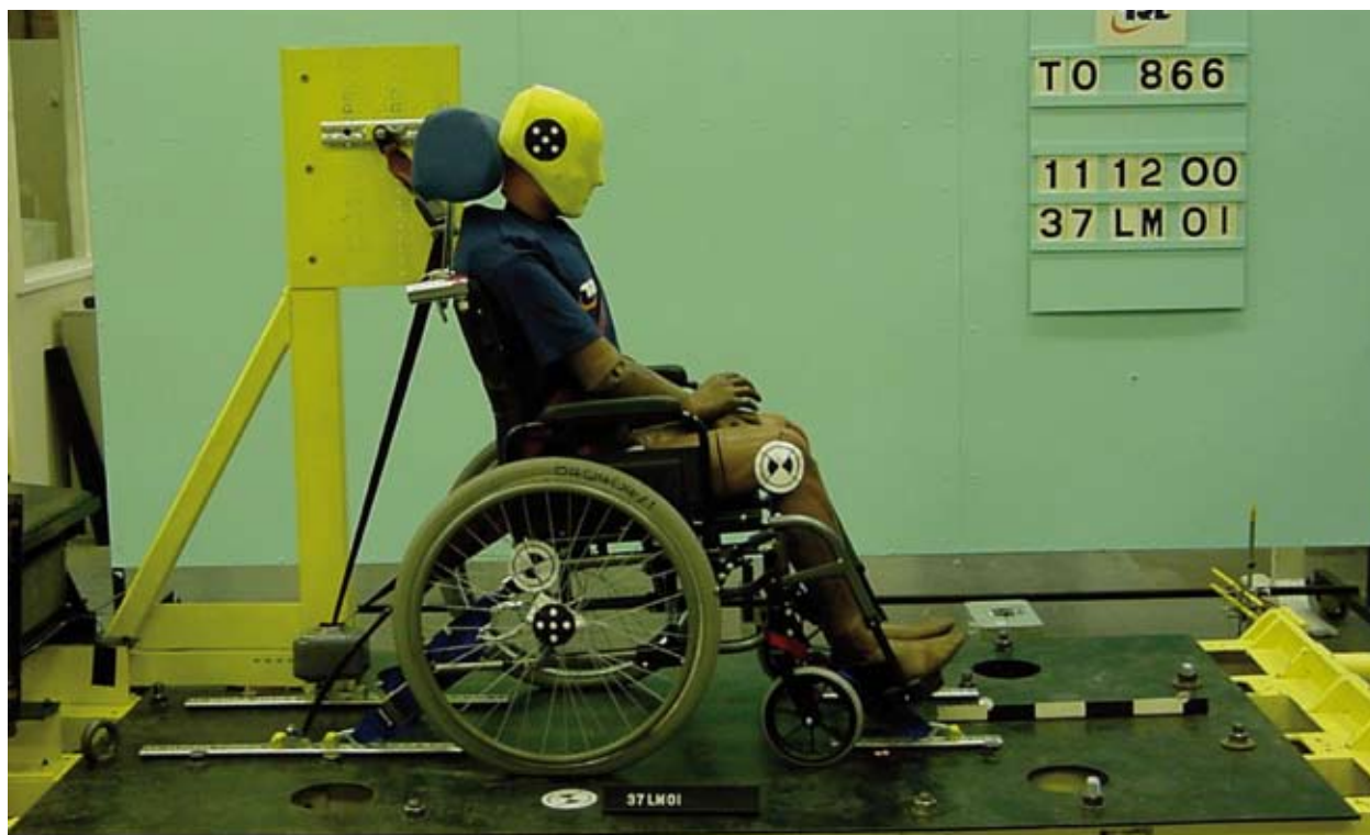
Fauteuil roulant arrimé aux rails, avant l'impact
