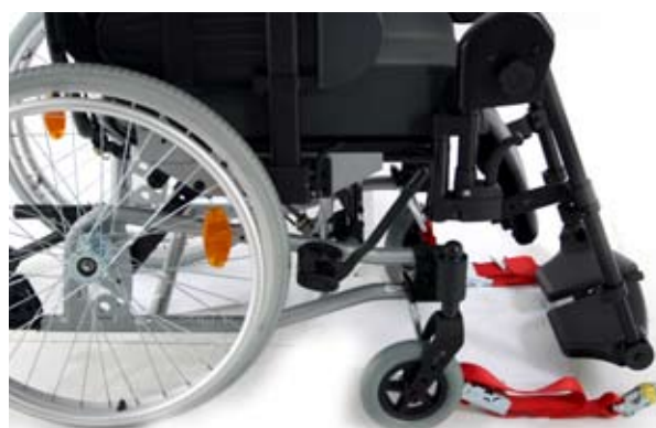
Point d'attache avant du fauteuil
