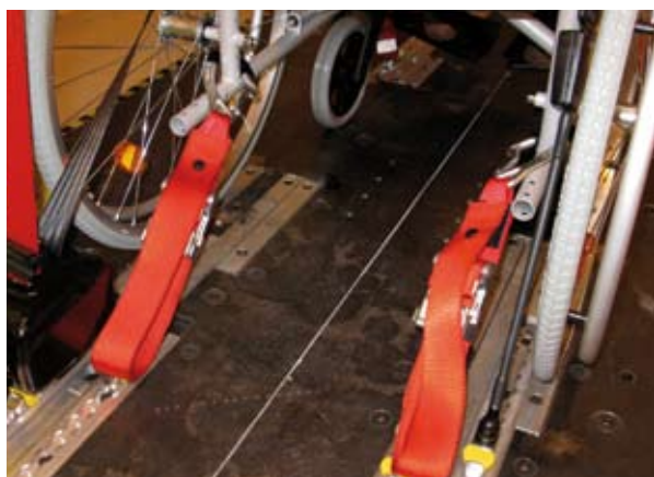
Point d'attache arrière du fauteuil
