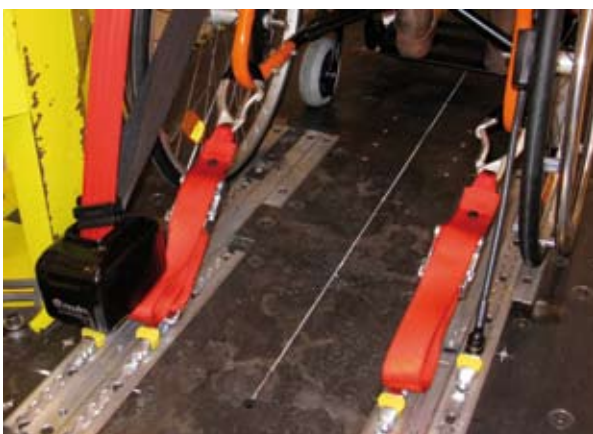
Point d'attache arrière du fauteuil
