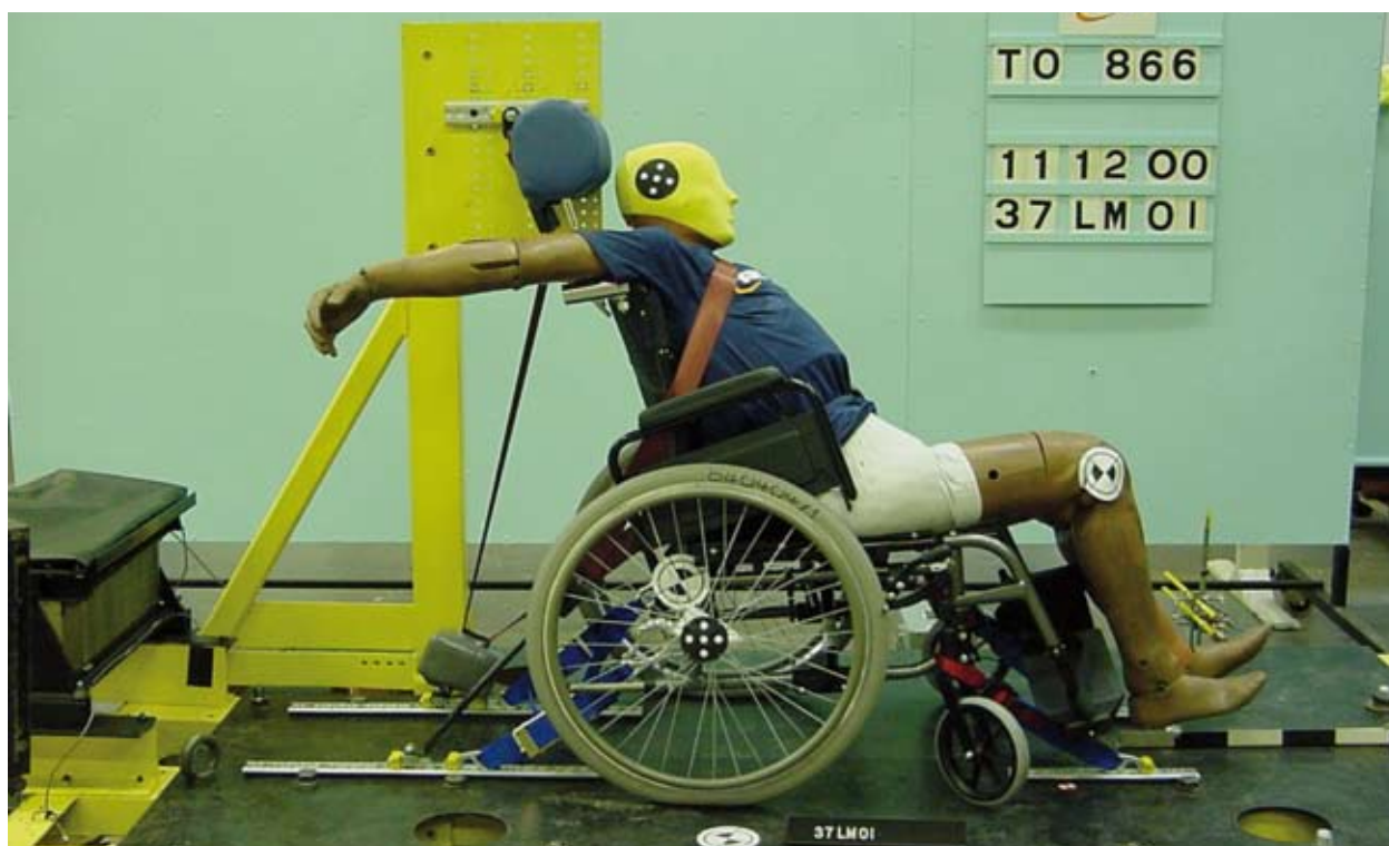
Fauteuil roulant arrimé aux rails, après l'impact
