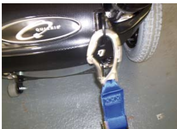
Point d'attache arrière du fauteuil
