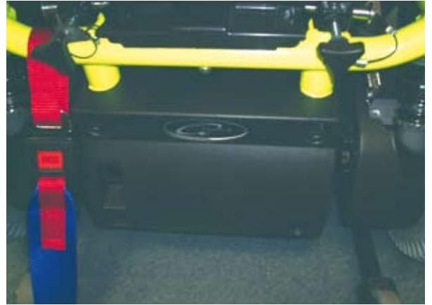
Point d'attache avant du fauteuil
