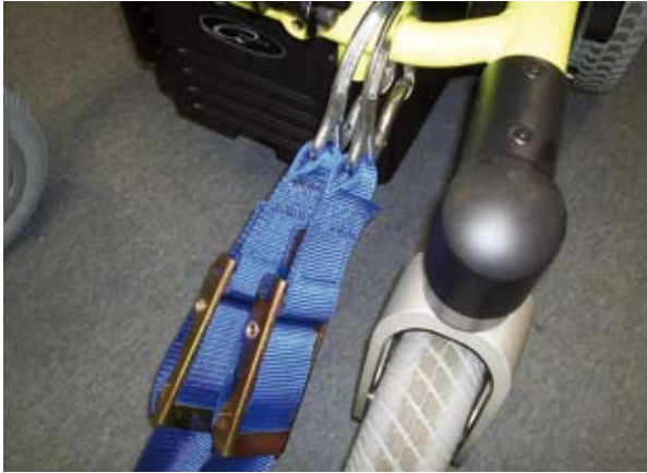
Point d'attache arrière du fauteuil Attention : deux sangles de chaque côté
