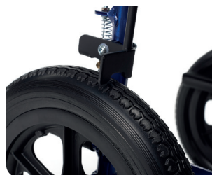
Freins avec position parking pour l'utilisateur et la tierce-personne
