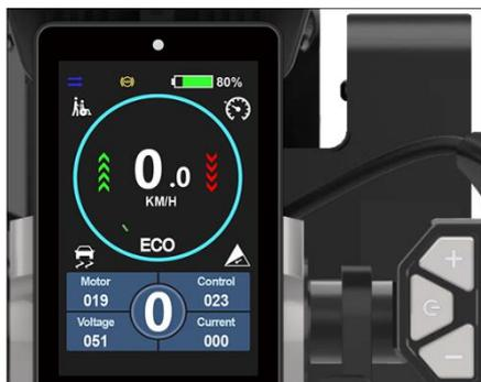
**Figure 40. Bouton d'alimentation et boutons de sélection du mode**
