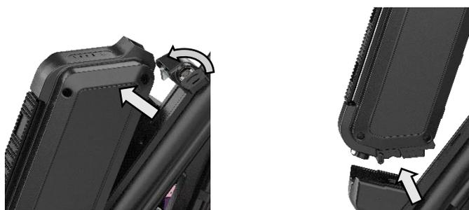
**Figure 44. Retrait et remplacement de la batterie.**
