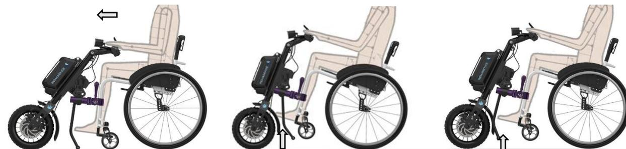
**Figure 38. Parking (1), City (3) et Touring (2) position pour le dispositif avec la pince/l'élévateur manuel**
