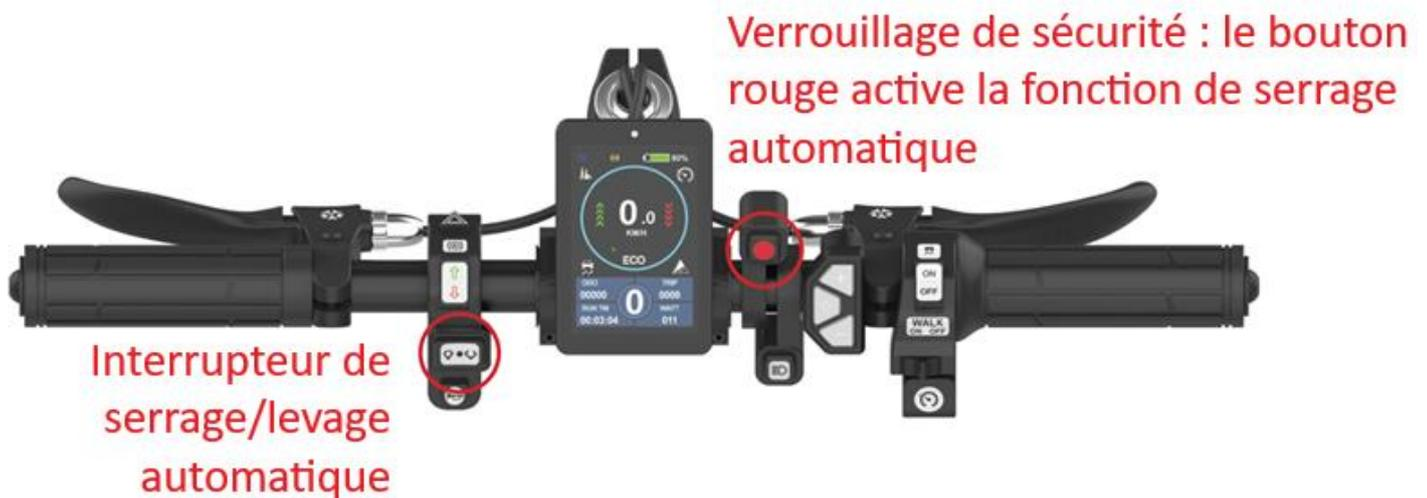
Figure 10. Interrupteur de serrage/levage automatique
