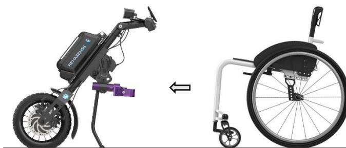
**Figure 32. Approchez le fauteuil roulant du dispositif**
